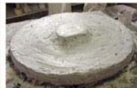
Rubberen mal van gipsen steunkap voorzien.
