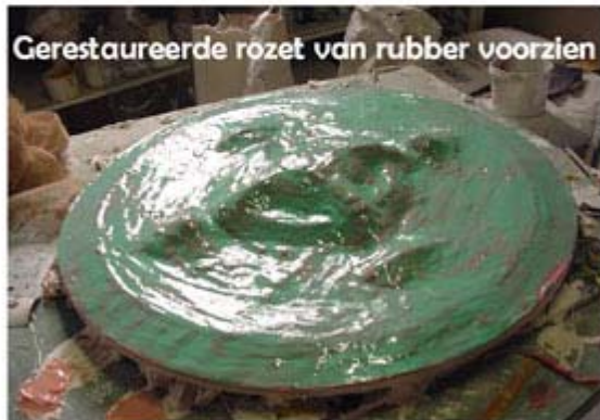
Rubberen mal van gipsen steunkap voorzien.
